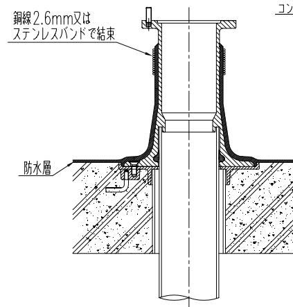
4. 断熱材・押さえコンクリートを施工し、カバー、ベントキャップを取り付け、施工完了です。
