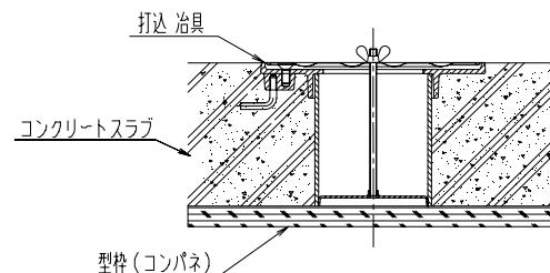
2. 型枠を解体し、打込治具付属の皿ピスで防水継手本体と固定し、通気管を差し込みます。
