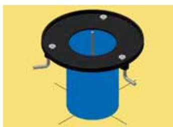
4. 保護カバーの穴に、全ねじボルトを通し、ちようナットで締め付け固定します。
