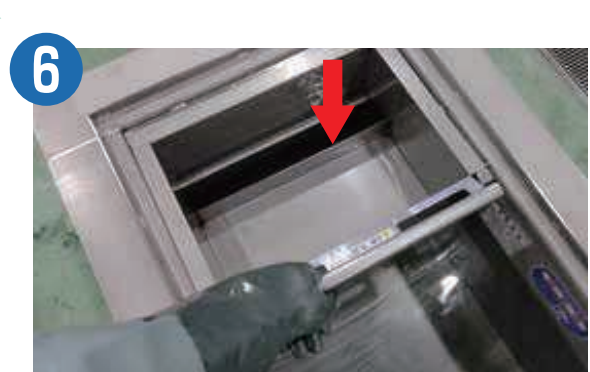
6 仕切板等部品を元に戻して完了です。
