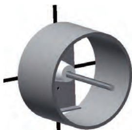
②全ねじボルトを取り付けスペーサーを置きます。
