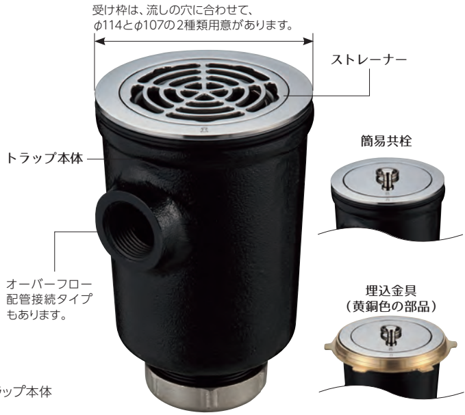
流し金具用トラップ基本構成 Model : T14AA-K-OF(SU)
