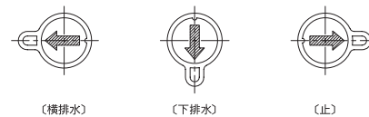
バルブハンドルの向きと排水方向
