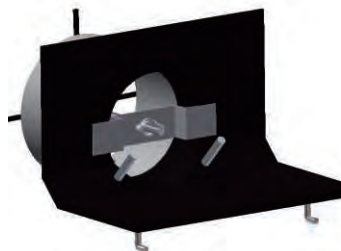
③本体をセットし、固定金具で締め付けます。
