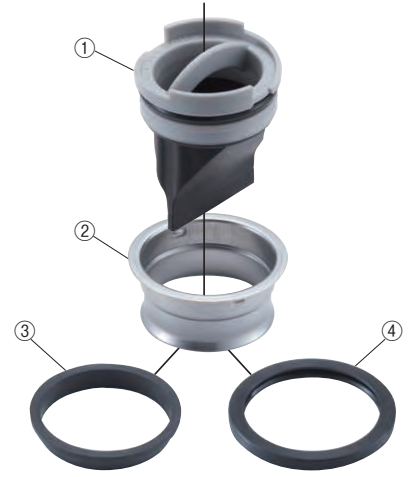
白ガス管に設置する際は部番③三角パッキンをご使用ください。床排水トラップに設置する際は部番④Uパッキンをご使用ください。
