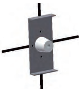
①型枠に十字線を引き、Pコンと位置決め板で固定してください。
